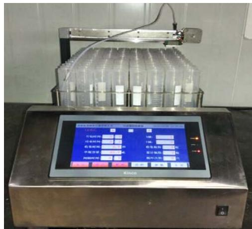
GL-LF096 餾分收集器圖 GL-LF096 Fraction Collector
